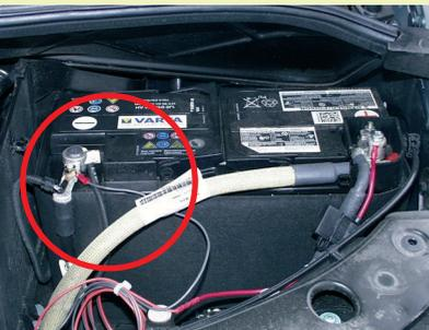
4. Verbinden Sie die schwarze Leitung mit Masse bzw. dem Minuspol der Batterie.
